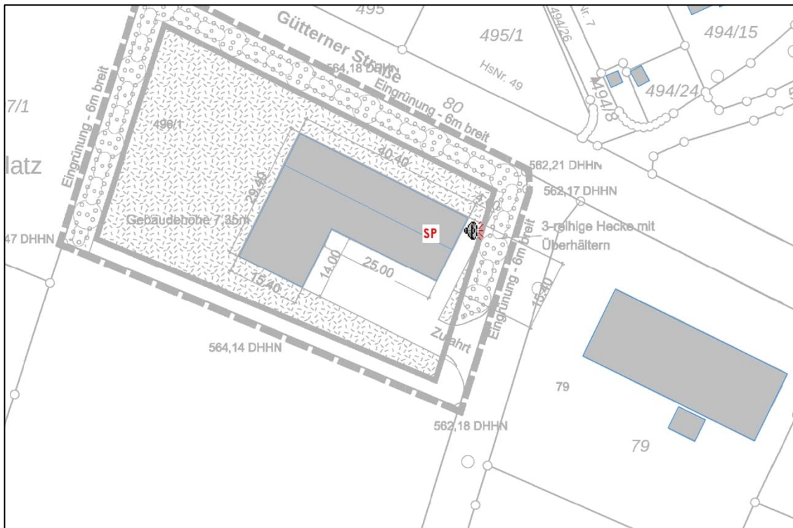
Abbildung 15: Lageplan mit Darstellung der Punktschallquelle SP (Spitzenpegel)
